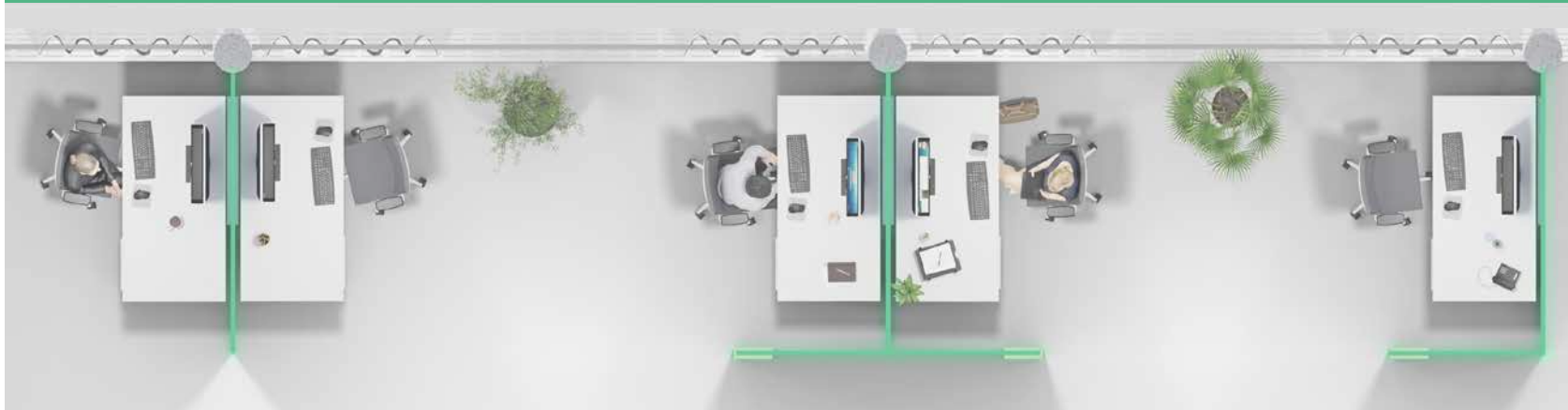
Glastrennwandsystem kombiniert mit Nahfeldschirmung durch Wandpaneele
